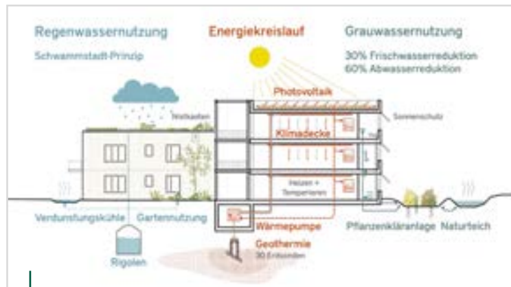
Grafik Geothermie, Photovoltaik und Grauwassernutzung
