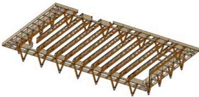
Bild 4: Das Dachtragwerk besteht aus 14 Fachwerkbindern von 28 m Länge, die im Achsabstand von rund 3 m angeordnet sind. Sie kragen als Dachüberstand beidseitig aus bzw. erhielten an den Schmalseiten entsprechende Giebelträger. (Isometrie: Holzbau Amann)
