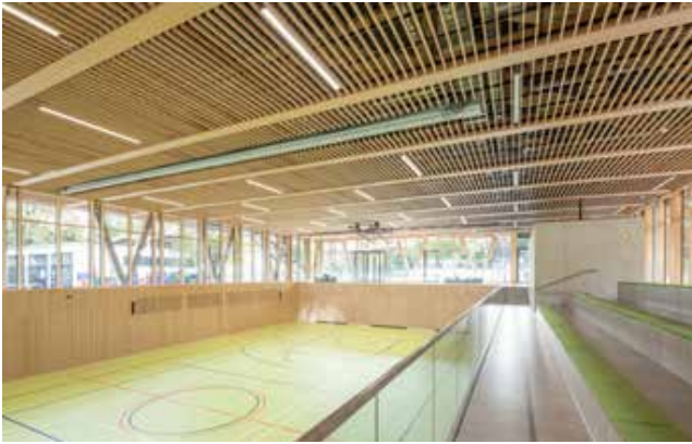
Bild 3a: Der Sportbereich der Halle liegt 3,40 m abgesenkt im Untergeschoss. Die Verglasung im Erdgeschoss sorgt für viel Tageslicht. (Foto: Margot Gottschling)
